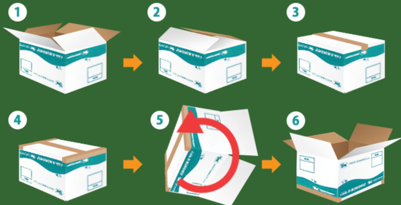
箱をさかさまにして底のダンボールを合わせ、縦にテープを貼ります。補強のため、横向きにも図のようにテープを貼りましょう。
